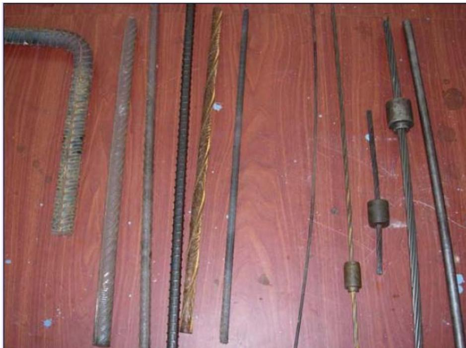
FIGURA 1-3 - ARMADURAS DE CONCRETO ARMADO E PROTENDIDO
