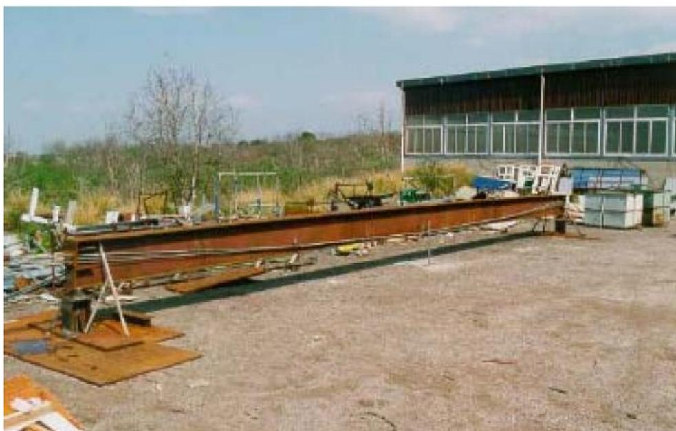
FIGURA 1-1- VIGA METÁLICA PROTENDIDA PARA ENSAIO
