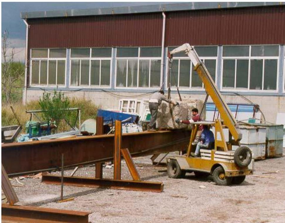
FIGURA 2-31 - CARREGAMENTO DA VIGA DO ENSAIO DE NUNZIATA (1999)
