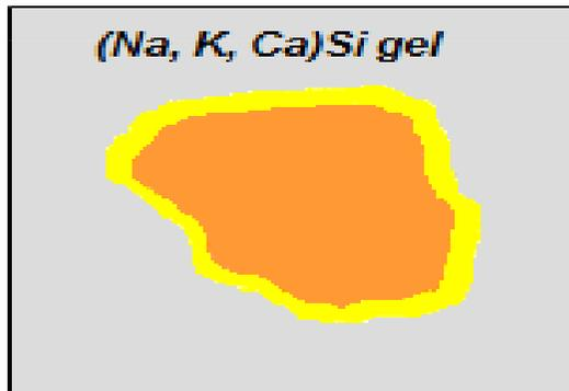
b) O produto da reação é o gel de álcali-sílica, composto por Na, K, Ca & Si. O Gel se forma em torno do agregado.
