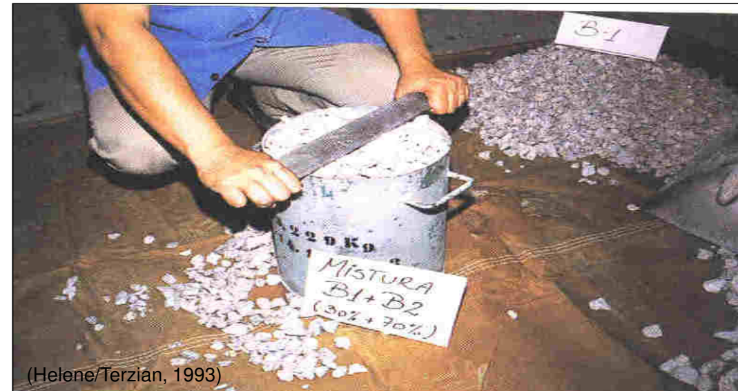
Mistura compactada sofrendo arrasamento
