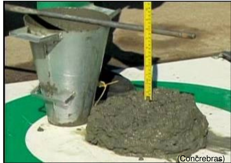
Abatimento de tronco de cone “ slump test ”
