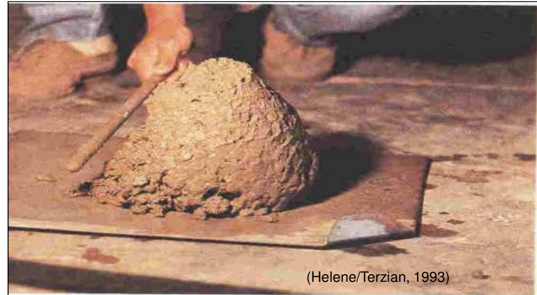
Concreto coeso, sem o desprendimento de agregados graúdos
