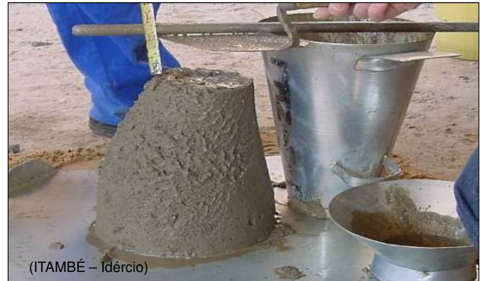
Superfície compacta, sem vazios, indicando o teor ideal de argamassa.
