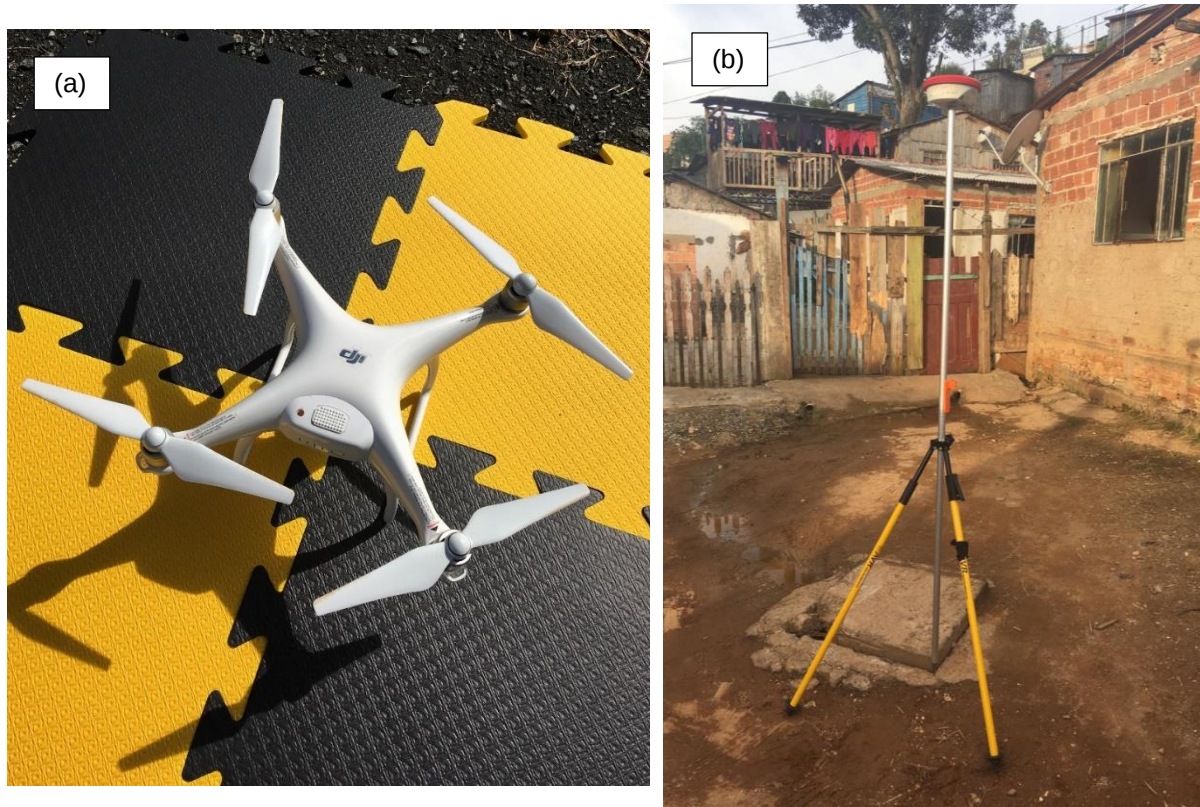
Figura 15 - Equipamentos utilizados no levantamento topográfico: (a) Veículo Aéreo Não Tripulado (VANT) para aerolevantamento; (b) GPS900CS para georeferenciamento
