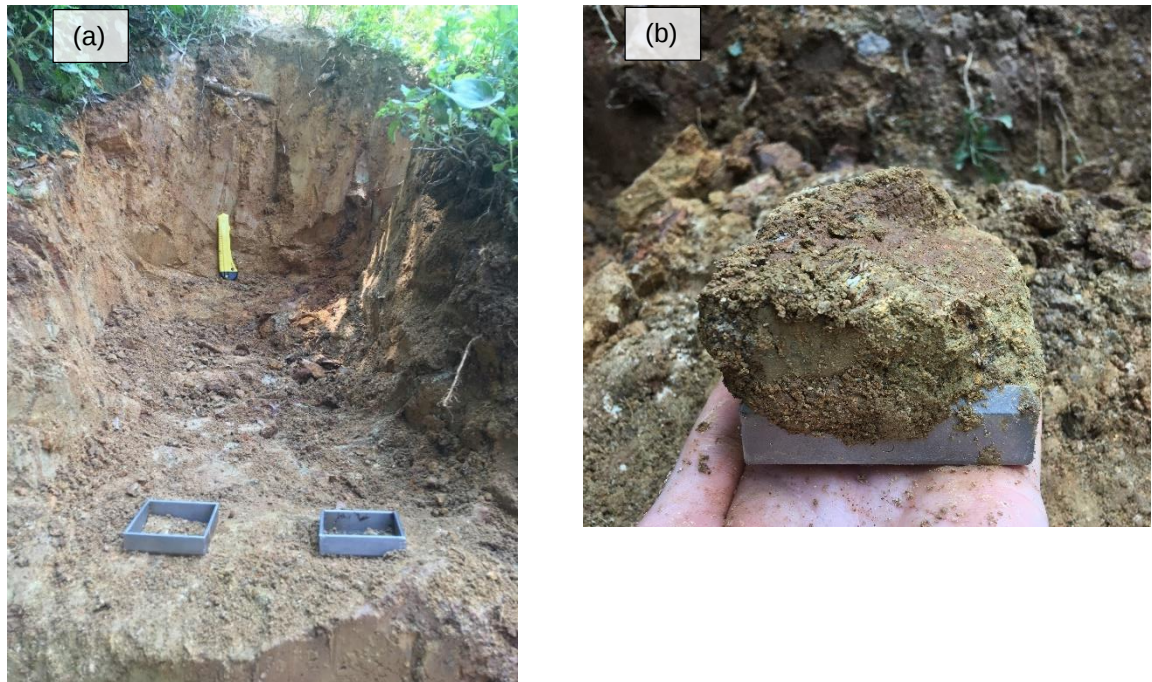
Figura 21 – Coleta da amostra indeformada de solo residual diretamente nas células de cisalhamento. (a) poço e profundidade de coleta; (b) detalhe da amostra amarela esverdeava com veios argilosos
