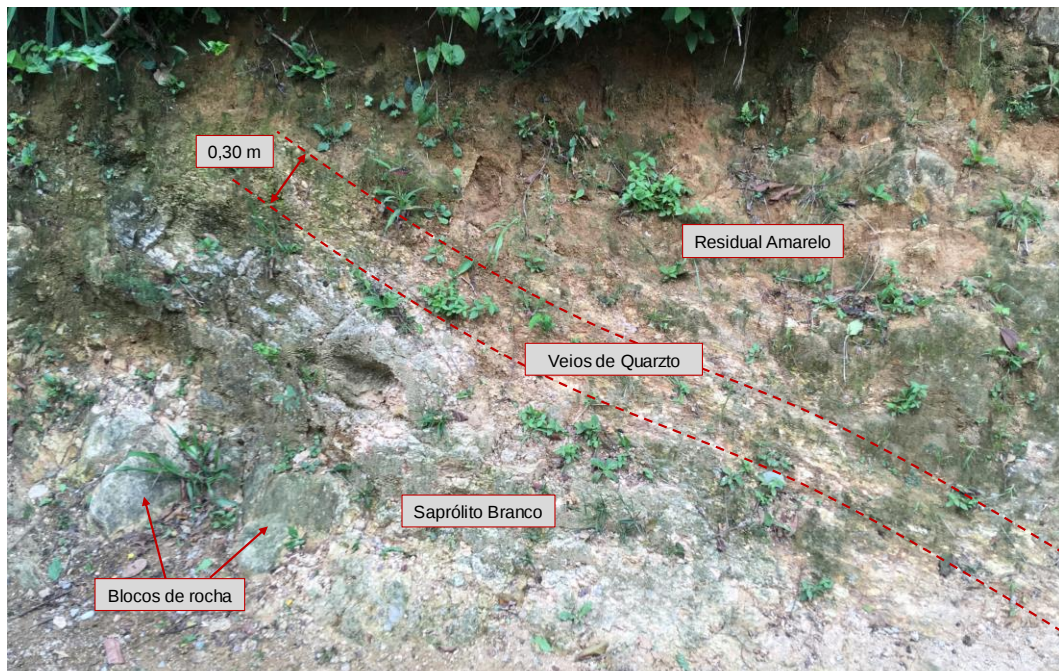
Figura 22 - Perfil de alteração de solo residual típico de Vila Nova (complexo gnáissico migmatítico) – afloramento R-2
