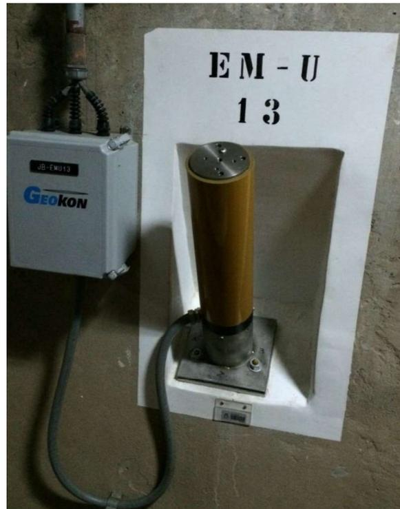
FIGURA 5 - EXTENSÔMETRO DE HASTES MÚLTIPLAS INSTALADO NO TRECHO U DA USINA DE ITAIPU
