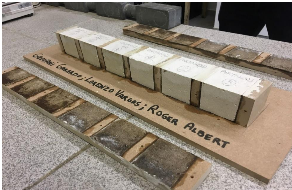
Figura 10 – Desforma de CP's para o ensaio de permeabilidade (Os autores, 2019).
