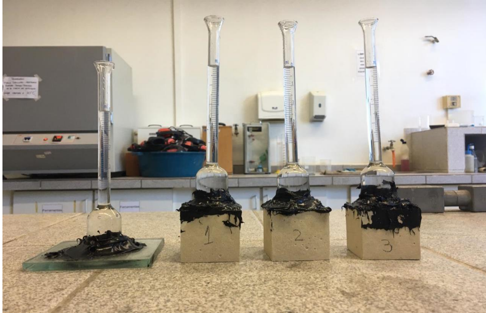
Figura 11 – Execução do ensaio de permeabilidade para a amostra CR1 (Os autores, 2019).
