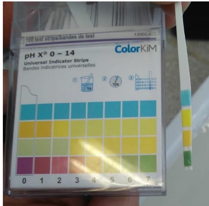
Figura 3 – Tira universal de pH após imersão na solução agressiva (Os autores, 2019).
