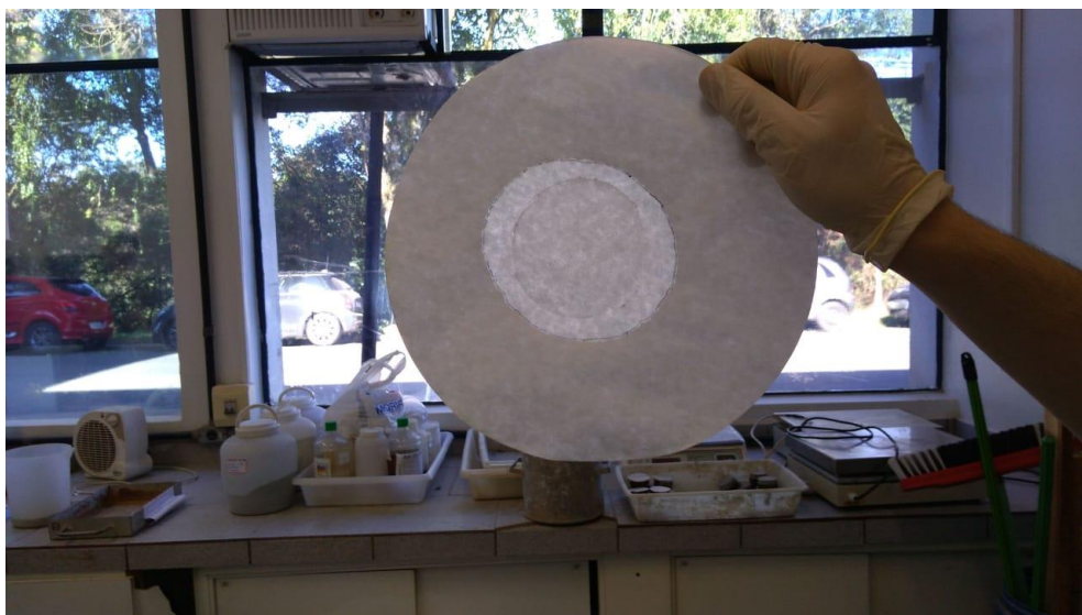
Figura 5 – Resultado do ensaio de retenção de água para a amostra R3 (Os autores, 2019).
