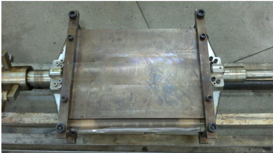
**Figura 2:** conjunto molde e placas de prensagem.
