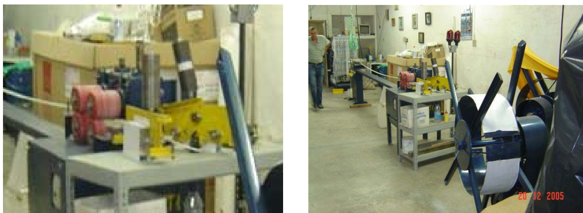
Figura 2 – Dispositivo de retesamento das fibras e bobinas de estocagem (Fonte: acervo particular da empresa WINCRET)
