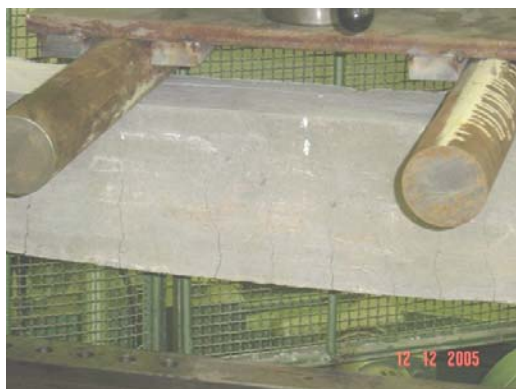
Figura 12 - Alastramento das fissuras no trecho de momento constante
