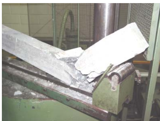
Figura 13 - Modo de ruptura catastrófica controlado pelas barras de GFRP
