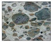
Estrutura macroscópica do concreto são bem visíveis os agregados e a pasta.
