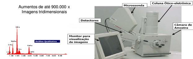
Detectores      Microsonda      Coluna Ótico-eletrônica
